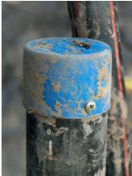
zajištění konců sond proti vniknutí nečistot
