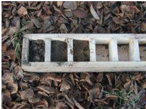
odebírání vrtného materiálu do vzorkovnice
